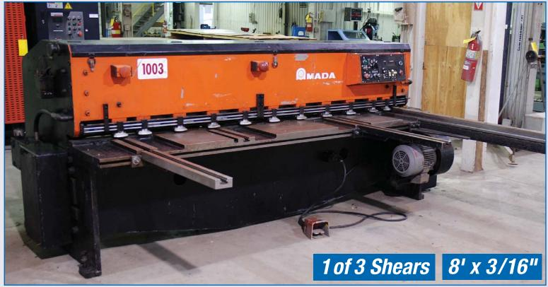
**AMADA** MODEL M2545 MECHANICAL SHEAR
