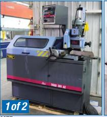
MEP 12" FULLY AUTOMATIC COLD SAW, MODEL TIGER 300AX
